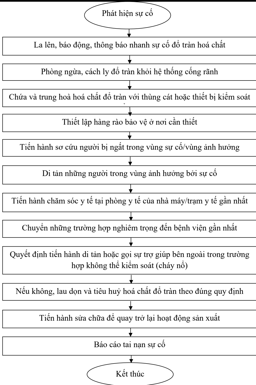
Hình 4.7. Sơ đồ quy trình ứng phó sự cố tràn hóa chất
